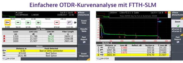
FTTH-SLM (SmartLink Mapper) ist eine OTDR-Anwendung zum Testen von FTTH-/PON-Netzen, um jedes einzelne Netzsegment sowie passive Komponenten, wie Splitter, Steckverbinder und Splice, zu charakterisieren. Die Software passt die Testparameter dynamisch an und führt automatisch mehrere Messungen durch, um optimale Ergebnisse zu erzielen. Alle erfassten Daten werden in einer einzigen symbolbasierten Anzeige und in Form einer kombinierten OTDR-Kurve dargestellt.
